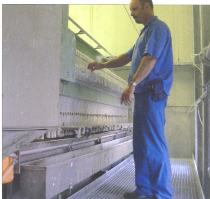
De opstelling van de filterpers.
